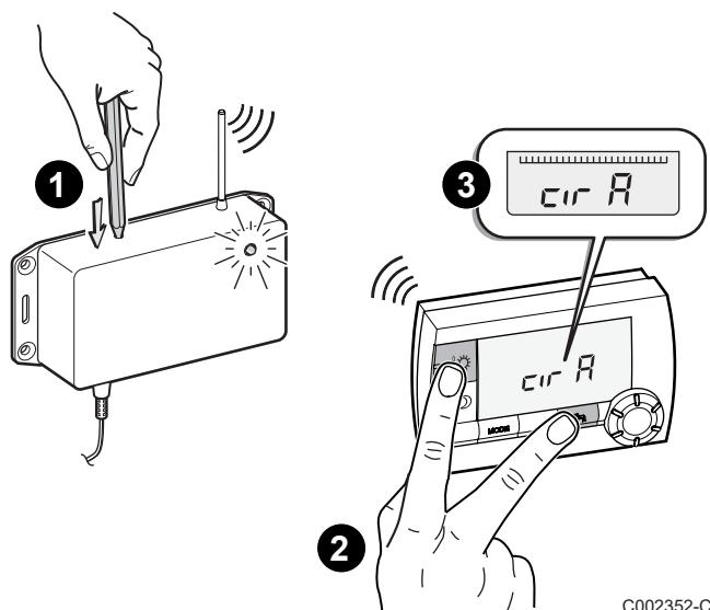
**1** Apretar el pulsador del módulo de radio usando la punta de un bolígrafo o similar. Se enciende el piloto del módulo de radio.
