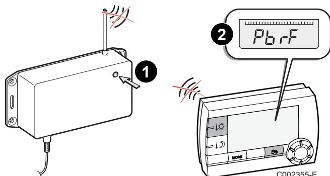
**1** In geval van problemen dooft het lampje na 2 minuten en geeft de afstandsbediening het bericht **Pb rF** weer.
