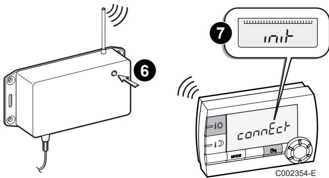
**6** **7** Au bout de quelques secondes, le voyant du module radio s'éteint et la commande à distance affiche le message "init", le temps de se synchroniser avec le module.
