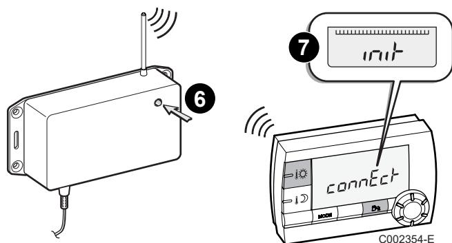
**6** **7** По истечении нескольких секунд индикатор радиопередатчика гаснет и на диалоговом модуле в течение нескольких секунд отображается "init" - это момент синхронизации с радиопередатчиком.
