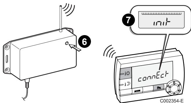
**6** **7** Despues de unos pocos segundos, el piloto del módulo de radio se apaga y en el mando a distancia aparece el mensaje "init" mientras se sincroniza con el módulo.
