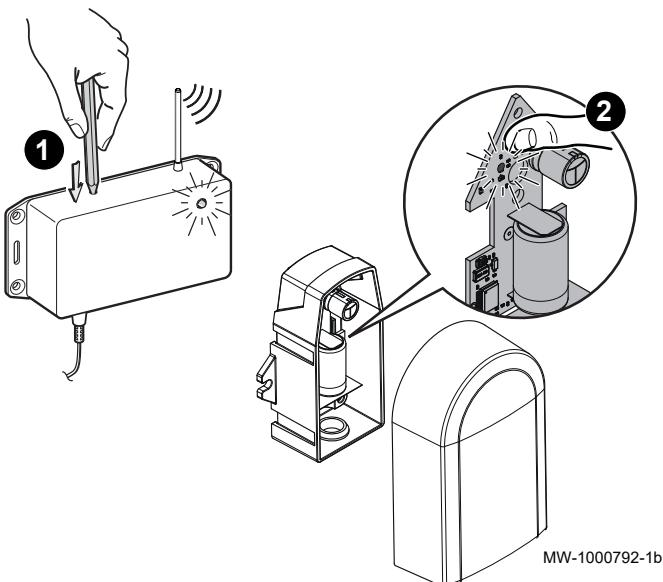
Iedere buitensor heeft standaard een uniek identificatienummer waarmee de radiomodule deze herkennen kan. Dit identificatienummer wordt aan de radiomodule doorgegeven door de hierna beschreven combinatisequentie.
