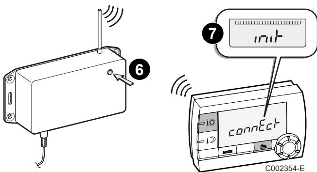
**6** **7** Nach ein paar Sekunden verlischt die Leuchte des Funkmoduls und die Fernbedienung zeigt die Meldung "init" an, während die Synchronisation mit dem Modul erfolgt.
