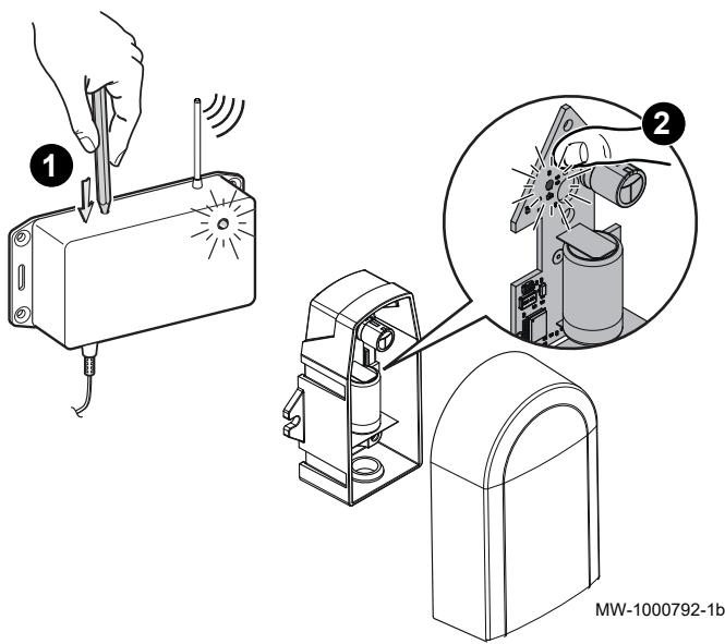
Todas las sondas exteriores llevan de fábrica un número de identificación único que permite que el módulo de radio las reconozca. Este número de identificación se transmite al módulo de radio mediante la secuencia de búsqueda de par que se describe a continuación.
