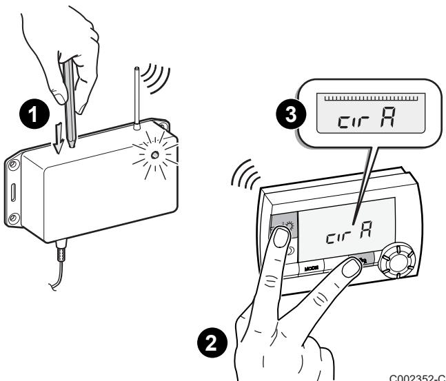
**1** Appuyer sur le bouton poussoir du module radio à l'aide d'une pointe de stylo. Le voyant du module radio s'allume.
