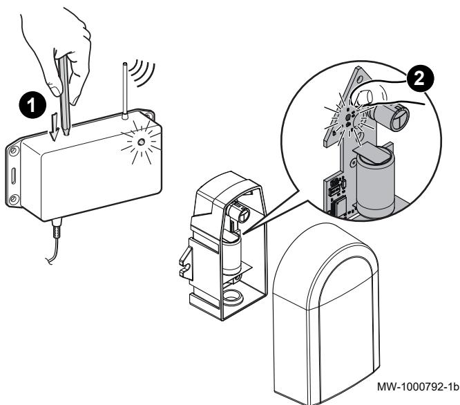
Chaque sonde extérieure intègre d'usine un numéro d'identification unique qui permet au module radio de la reconnaître. Ce numéro d'identification est transmis au module radio par la séquence d'appairage décrite ci-après.
