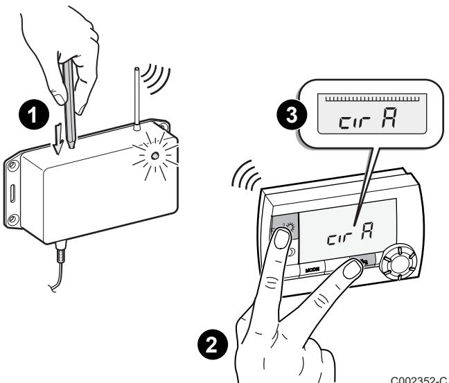
**1** Mit der Spitze eines Kugelschreibers die Taste des Funkmoduls drücken. Die Leuchte des Funkmoduls geht an.
