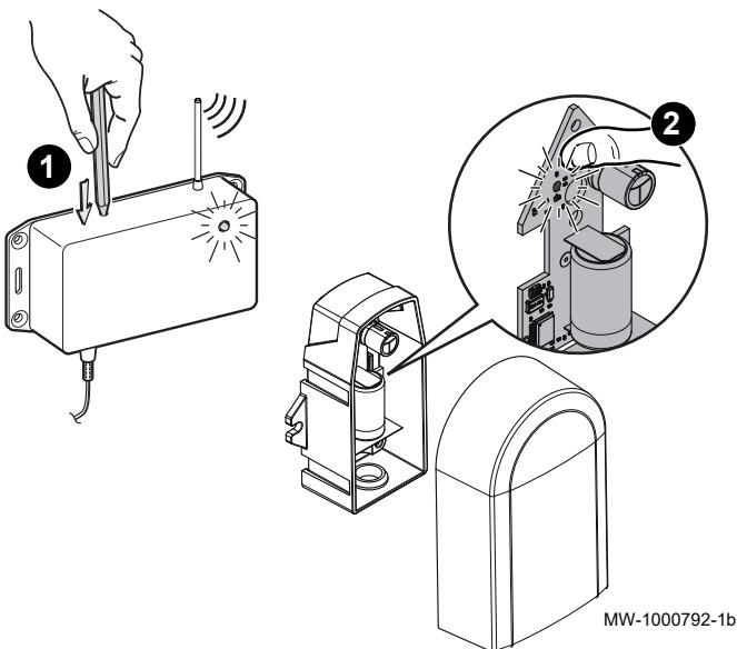
Jeder Außenfühler besitzt eine werksseitig eingestellte, unverwechselbare Identifikationsnummer, anhand der das Funkmodul ihn erkennen kann. Diese Identifikationsnummer wird durch die nachstehend beschriebene Paarungssequenz an das Funkmodul gesendet.
