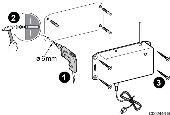
Закрепить радиопередатчик на стене рядом с котлом, чтобы обеспечить подключение в панели управления котла. Использовать поставляемые 4 шурупа + 4 дюбеля.
