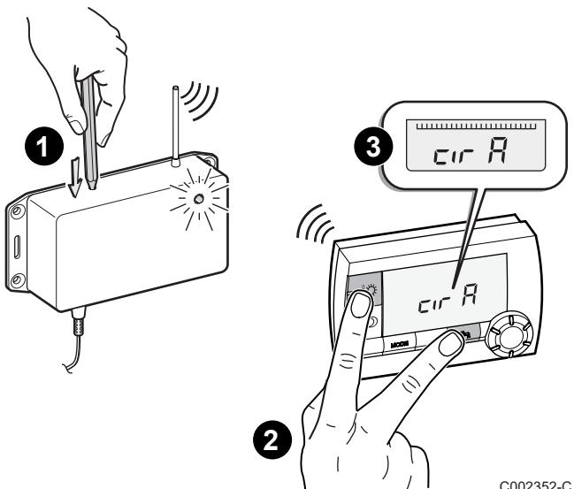
**1** Premere il pulsante test del modulo radio con la punta di una penna a sfera. La spia del modulo radio si accende.
