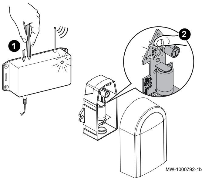
Każdemu czujnikowi temperatury zewnętrznej przydzielono w fabryce unikalny numer identyfikacyjny, który umożliwia rozpoznanie go przez moduł radiowy. Ten numer identyfikacyjny jest przesyłany do modułu radiowego poprzez sekwencję kojarzenia opisaną poniżej.
