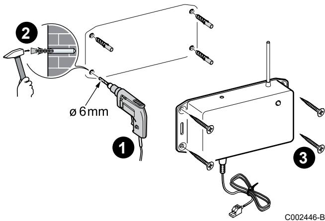
El módulo de radio se fija en la pared cerca del generador de calefacción para poder conectar el generador al cuadro de mando. Utilizar los 4 tornillos + 4 tacos suministrados.
