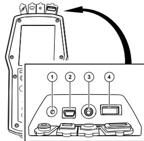
**Anschlüsse am Differenzdruckfühler**
