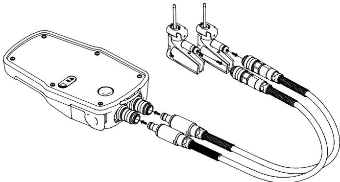
**Zuerst** – Die Sicherheitsdrucksonden (SPP) an die Messschläuche anschließen, die wiederum mit dem Dp-Sensor verbunden werden, dabei auf die Farbkennzeichnungen achten.
