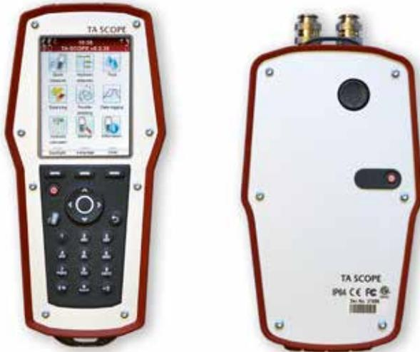
Das TA-SCOPE ist ein robuster und effektiver Einregulierungscomputer zur genauen Messung und Dokumentierung von Differenzdruck ( $\Delta p$ ), Durchfluss, Temperatur und Leistung in hydraulischen Systemen.
