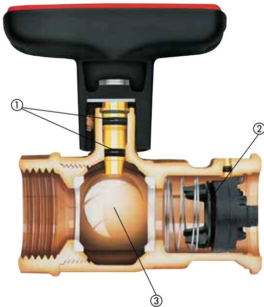
1. Spindelabdichtung durch zwei O-Ringe
