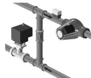
Vergewissern Sie sich, dass die Oberfläche des Rohrs an der Stelle, wo Sie einen Anlegefühler anbringen, sauber und trocken ist. Nach der Montage sollte der Fühler keinen mechanischen Belastungen ausgesetzt sein, da es sonst zu Beschädigungen kommen kann.
