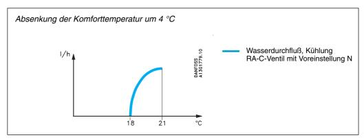
Der Regler wird für eine Absenkung der Komforttemperatur von 22 °C um 4 °C auf etwa 18 °C bei Xp = 0 K gedreht.
