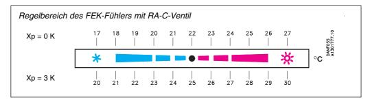
Bei einer Einstellung im blauen Temperaturbereich liegt der Einstellpunkt des Kühlkreises unterhalb der Komforttemperatur, d.h. das Ventil öffnet bei einer unter der Komforttemperatur von etwa 22 °C liegenden Temperatur. Bei einer Einstellung im roten Temperaturbereich liegt der Einstellpunkt des Kühlkreises oberhalb der Komforttemperatur. Das Ventil im Kühlkreis öffnet bei einer über der Komforttemperatur von etwa 22 °C liegenden Raumtemperatur.
