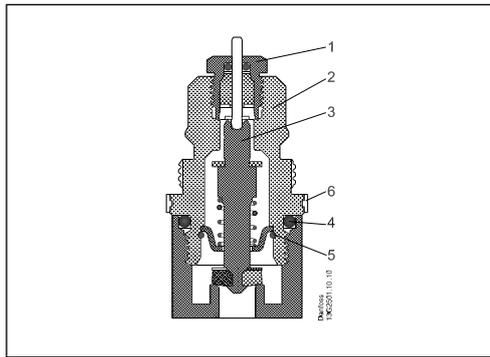
Die Ersatzlösung für RIGIS-Ventile besteht aus Ventileinsatz und Fühlerelement RA 2990 /2992, welche separat zu bestellen sind.
