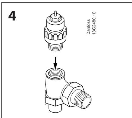
4 Der neue Ventileinsatz auf dem Ventil befestigen.
