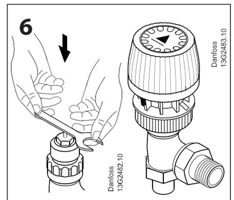
6 Schraube schieben, um für Schmutz zu kontrollieren. RA Fühler montieren.
