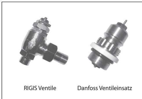
Die neuen Danfoss-Ventileinsätze für RIGIS-Ventile erlauben den Umbau von bestehenden RIGIS Handregulier-auf-Thermostatventile, ohne die bestehenden Ventile aufwendig auszutauschen. Als Fühler-elemente können alle der Serie RA 2000 z. B. RA 2990 oder 2992 verwendet werden. Der Ventileinsatz besteht aus Messing Ms 58 und Chromstahl und wird mit einer RA 2000 Stopfbüchse ausgerüstet, welche unter Druck ausgetauscht werden kann.
